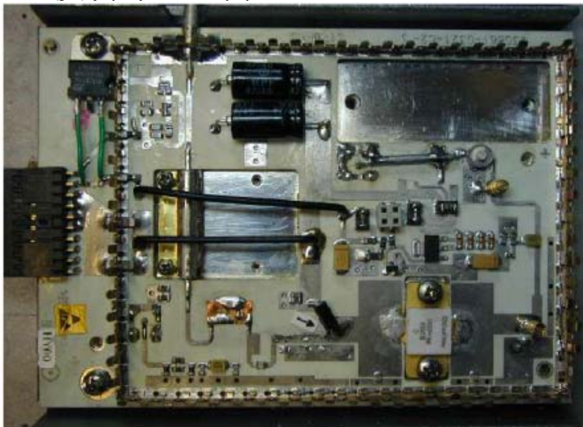
Rys. 6 Gotowy przerobiony stopień końcowy optymalizowany dla pasma 23 cm.
